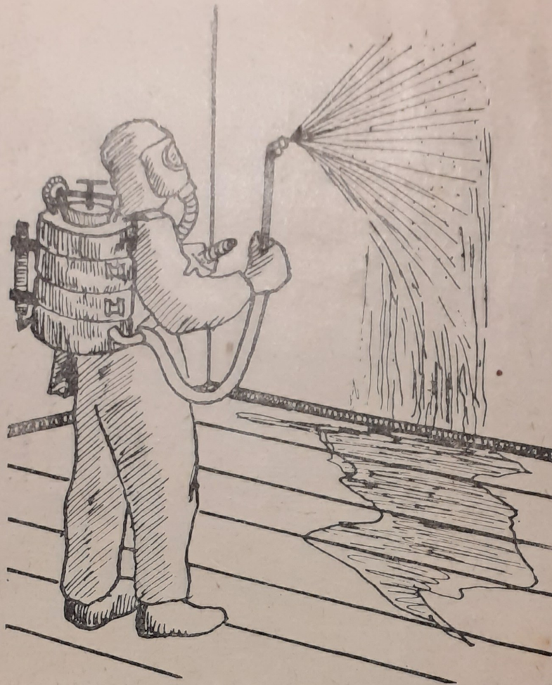
Rys. 17. Dezaktywacja pomieszczenia przy pomocy RDPS
